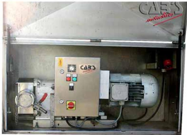
**Entraînement:** **UNIBLOC 551®** peut-être entraînée par moteur hydraulique, électrique ou encore par prise de mouvement.
